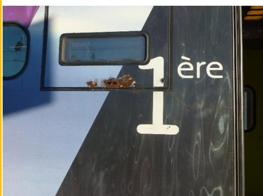
Photo prise lors de notre dernier pélé montrant des trous béants dus à la rouille.
